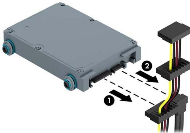
7. Pogon oslobođite tako da povučete zeleni jezičak za otpuštanje u smjeru suprotnom od pogona (1) te nakon toga izvučete pogon iz ležišta (2).
