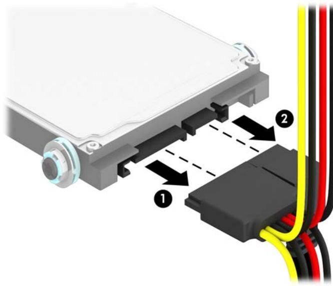
9. Povucite prema van polugu za otpuštanje na stražnjem dijelu pogona (1), zatim povucite pogon unatrag dok ne stane te ga izvucite iz ležišta pogona (2).
