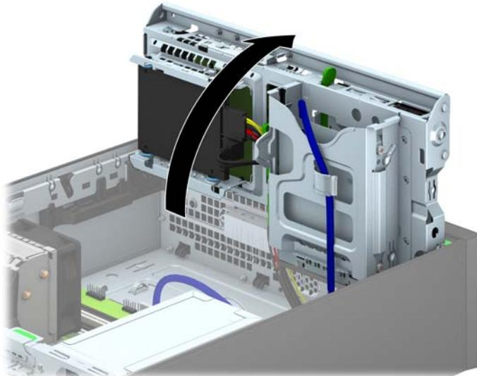
8. Odsvojite kabele pogona sa stražnje strane pogona ili, ako uklanjate čitač medijskih kartica, odspojite USB kabel s matične ploče kako je prikazano na sljedećoj slici.
