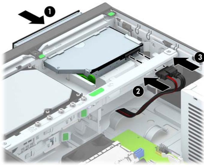
10. Spojite drugi kraj podatkovnog kabela na jednu svjetlo plavu SATA priključnicu na matičnoj ploči.
