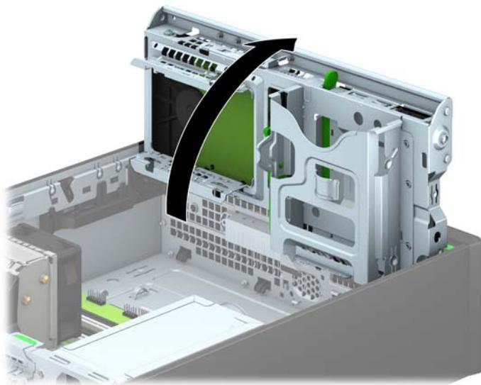
9. Poravnajte vijke za vođenje na pogonu s J-utorima sa strane ležišta pogona. Pričvrstite pogon u ležište pogona te gurnite prema naprijed dok se ne zaključa na mjestu.
