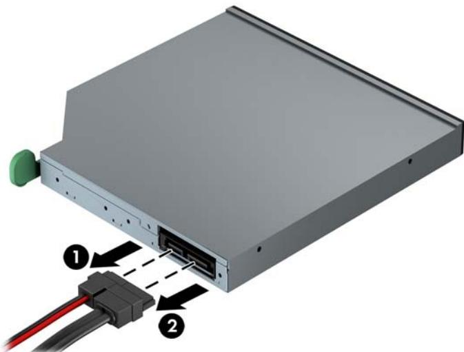
**OPREZ:** Kada uklanjate kabele, povucite jezičak ili priključnicu umjesto kabla da biste izbjegli oštećenje kabala.
