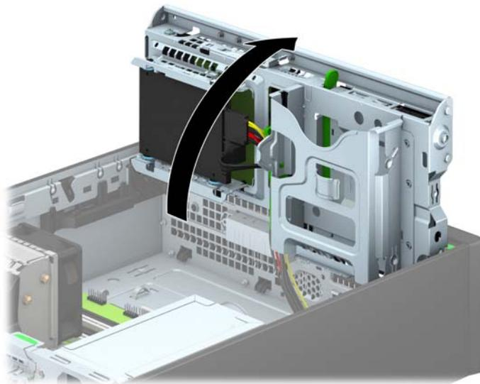
8. Iskopčajte kabel za napajanje (1) i podatkovni kabel (2) sa stražnje strane tvrdog diska.
