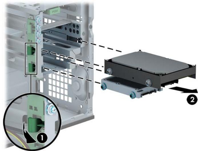
8. Skinite četiri vodeća vijka (dva sa svake strane) sa starog pogona. Ovi vijci će vam biti potrebni pri ugradnji novog pogona.
