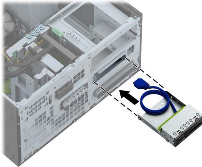
9. Bila memasang pembaca kartu media USB 3.0, Anda harus menggunakan adaptor USB 3.0 ke USB 2.0 dan hubungkan kabel adaptor dari pembaca kartu media ke konektor USB 2.0 pada papan sistem berlabel MEDIA.
