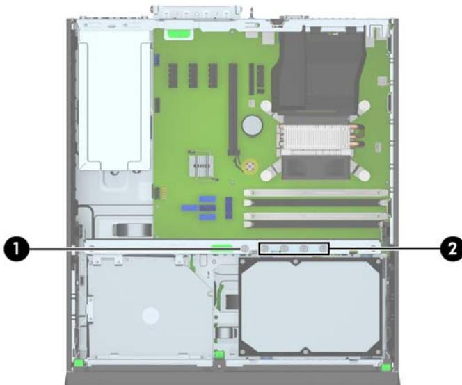
Terdapat total lima sekrup standar 6-32 tambahan berwarna perak. Satu digunakan untuk pengamanan bezel (1) (untuk informasi lebih lanjut, lihat [Keamanan bezel depan pada hal. 101](#)). Keempat sekrup yang lain digunakan sebagai sekrup pemandu untuk pembaca kartu media atau hard drive sekunder di tempat drive 3,5 inci opsional (2).
