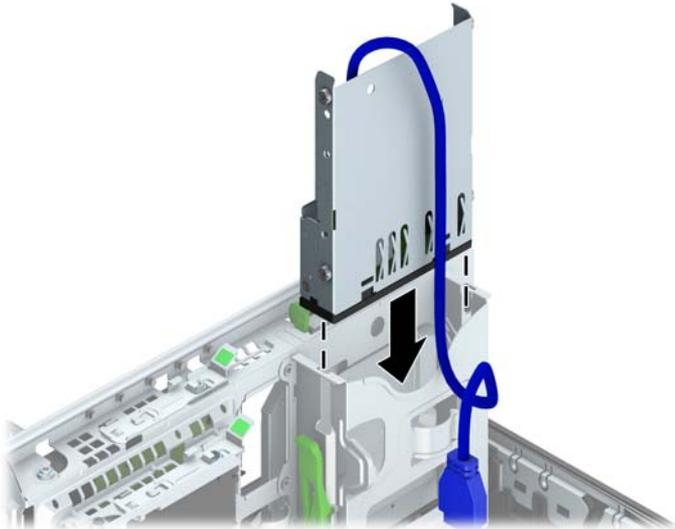
11. Bila memasang pembaca kartu media USB 3.0, Anda harus menggunakan adaptor USB 3.0 ke USB 2.0 dan hubungkan kabel adaptor dari pembaca kartu media ke konektor USB 2.0 pada papan sistem berlabel MEDIA.
