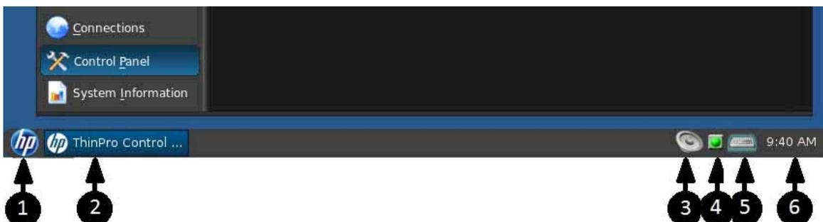
1. [HP]ボタン：HP ThinPro オペレーティング システムの基本機能（コントロールセンター、ログアウト、再起動、電源オフなどの機能）にアクセスできます。
