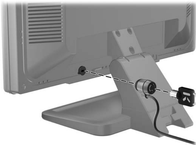
Figura 2-10 Instalación de un bloqueo de cable
