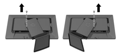
Retire los dos tornillos de montaje superiores (1) y luego levante la base y retírela del monitor (2).
