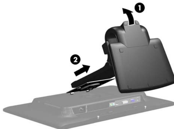
Figura 3-12 Remoção da Base Pedestal
