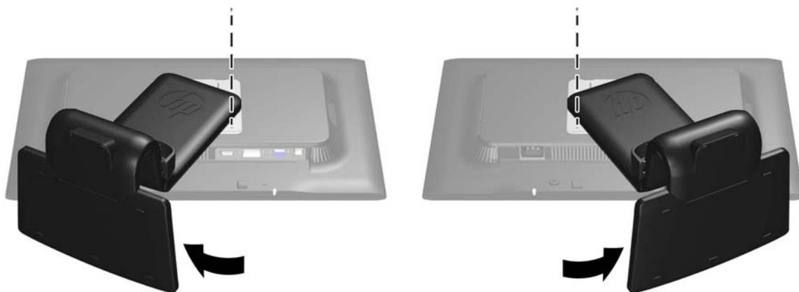
4. モニター台を上向きに回転させてから (1) 後方に引いて (2)、モニタースタンドのタブをモニター本体のロットから外します。
