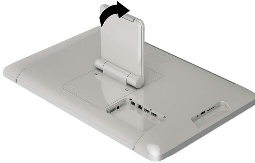
3. Entfernen Sie die beiden Schrauben, die den Ständer am All-in-One Gerät befestigen (1). Heben Sie dann die Unterseite des Ständers leicht an und nehmen Sie ihn vom All-in-One Gerät ab (2).
