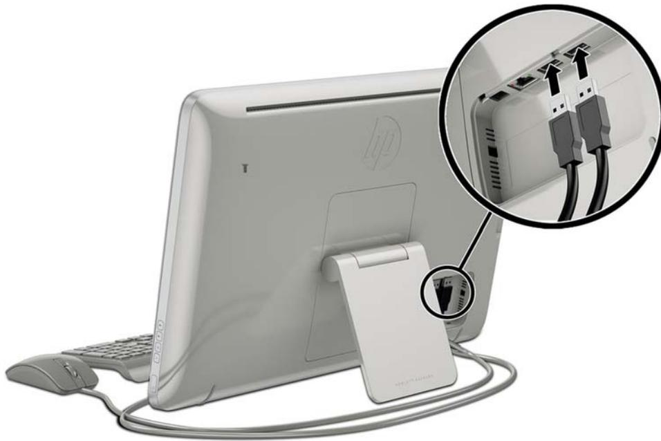
5. Verbinden Sie das DC-Kabel mit dem hinteren Netzanschluss des All-in-One Geräts (1) und das Netzkabel mit dem AC-Netzteil (2). Schließen Sie dann das andere Ende an einer Wandsteckdose an (3).
