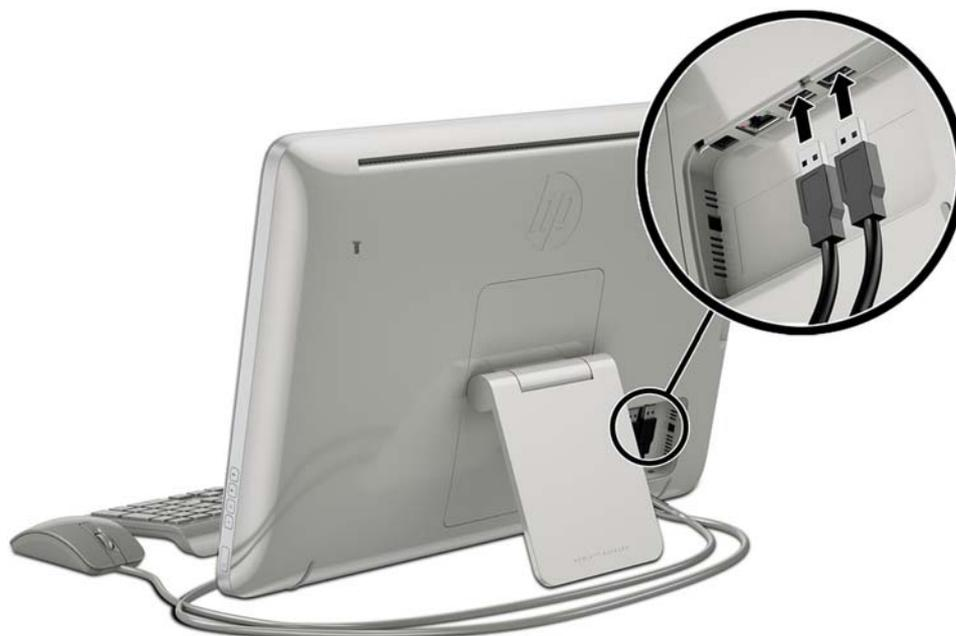
5. DC-in ケーブルをコンピューターの背面に接続した後 (1)、電源コードの一方の端を AC アダプターに接続し (2)、もう一方の端を電源コンセントに接続します (3)。
