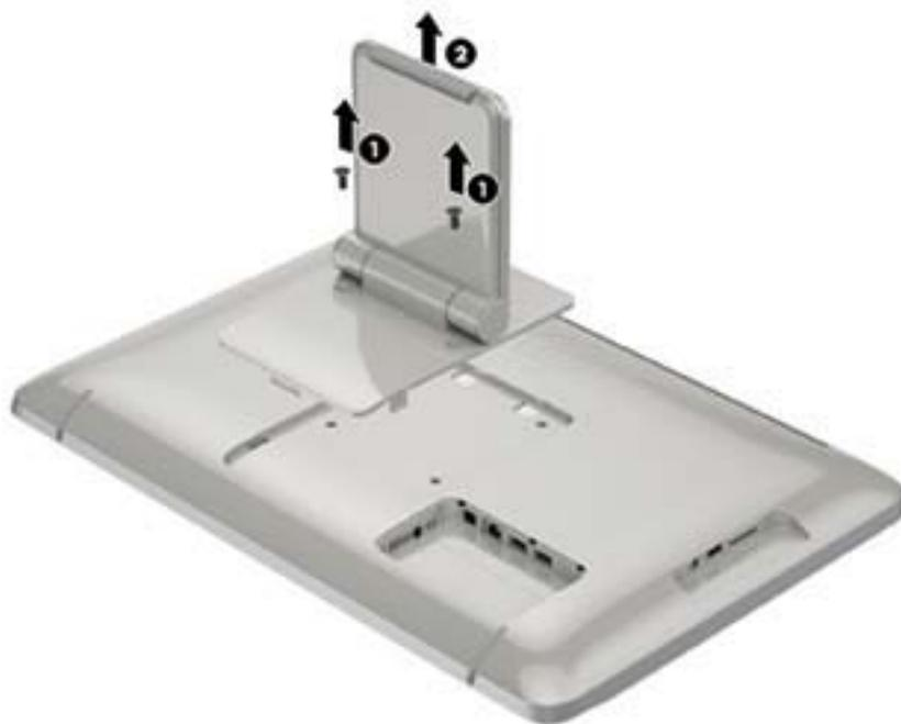
4. コンピューターの背面の VESA 準拠の取り付け穴の上に固定器具のネジ穴が重なるように置き、4 本の 10 mm ネジ（別売）を固定器具のネジ穴に通してからコンピューターのネジ穴に差し込みます。
