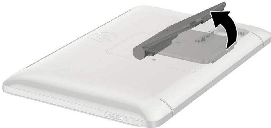
3. Levante el dispositivo multifuncional a una posición vertical y colóquelo en una superficie plana y estable.
