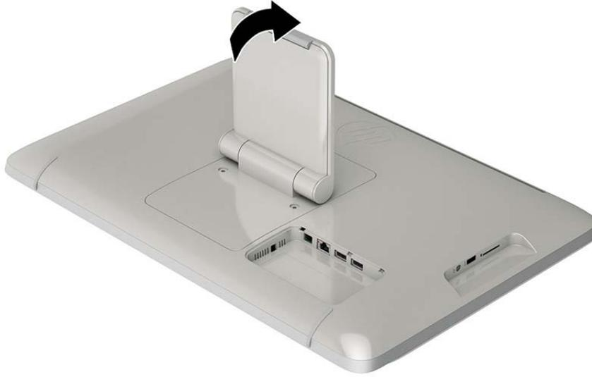
3. Retire los dos tornillos que sujetan la base al dispositivo multifuncional (1), y, a continuación, levante la parte inferior de la base ligeramente y quitela del dispositivo multifuncional (2).
