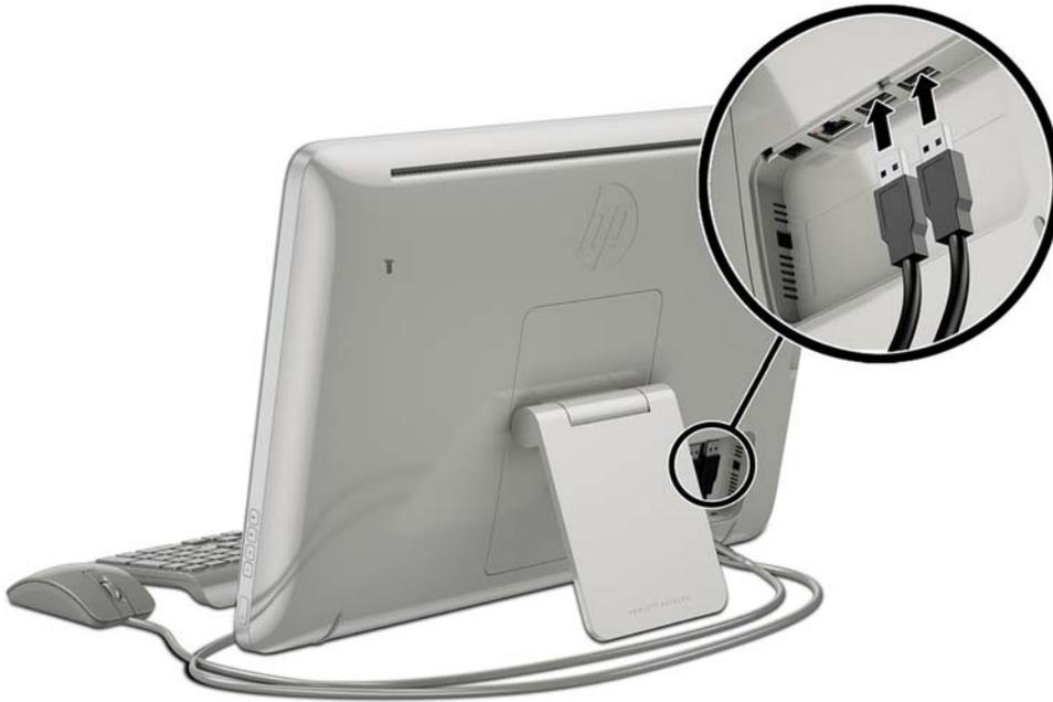
5. Conecte el cable de alimentación CC en la parte trasera del dispositivo multifuncional (1) y, a continuación, conecte el cable de alimentación en el adaptador de CA (2) y el otro extremo en una toma de corriente de pared (3).
