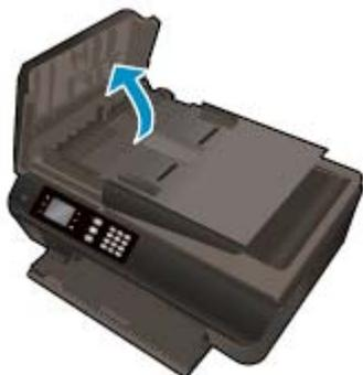
2. Поднимите устройство АПД за выступ, расположенный в передней части.
