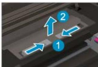
3. Нажмите на отверстие в крышке тракта подачи бумаги и поднимите крышку. Извлеките замятую бумагу.
