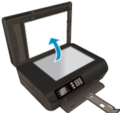
2. 將原稿列印面朝下放置在掃描器玻璃板的右側角落。
