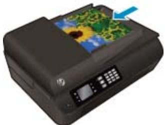
3. 將紙張寬度導板向內推，直到接觸到紙張邊緣後停止。
