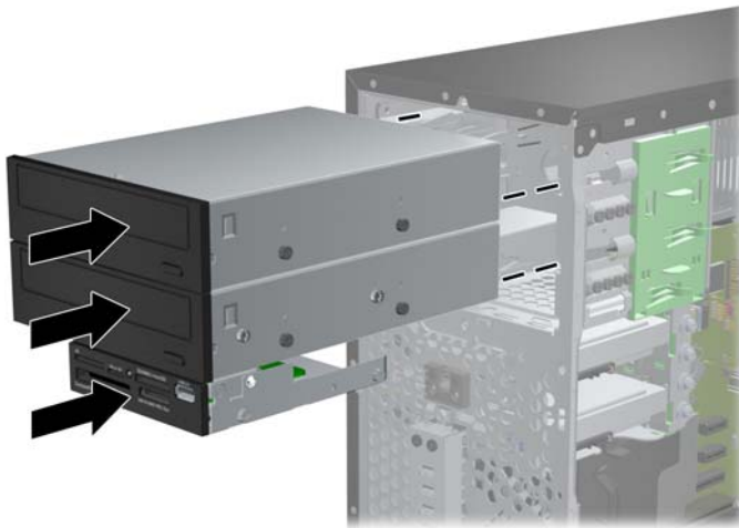
Abbildung 2-21 Hineinschieben des Laufwerks in den Laufwerkrahmen
