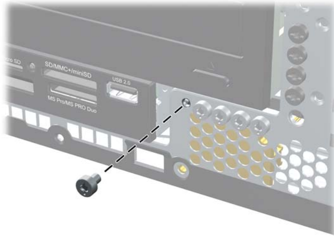
Abbildung 3-50 Entfernen der Sicherheitsschraube der Frontblende
