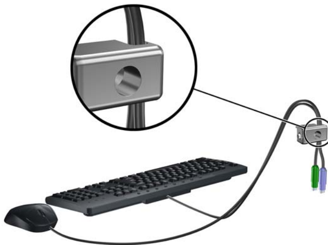
Abbildung 3-46 Führung der Tastatur- und Mauskabel
