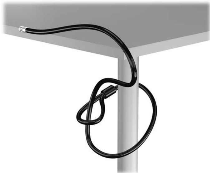
Abbildung 2-34 Befestigen des Kabels an einem feststehenden Gegenstand
