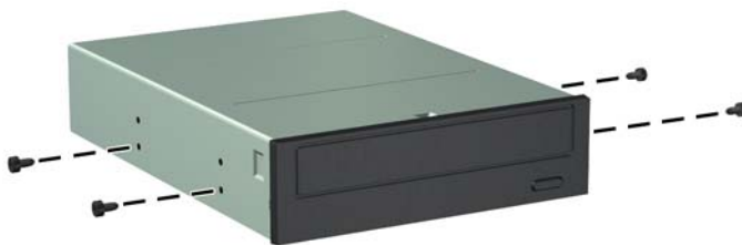
Abbildung 2-20 Anbringen von Führungsschrauben (optisches Laufwerk abgebildet)
