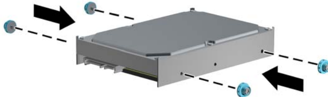
Abbildung 3-37 Anbringen der Festplattenführungsschrauben
