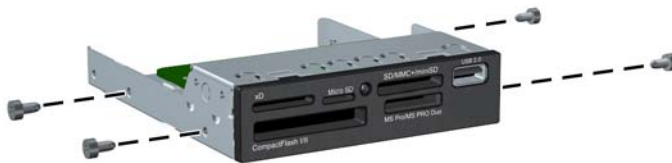
Abbildung 3-29 Anbringen von Führungsschrauben (Speicherkarten-Lesegerät abgebildet)
