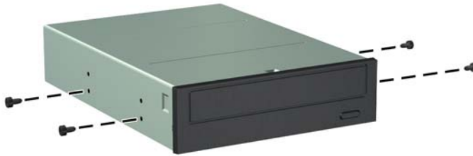
Abbildung 3-22 Anbringen von Führungsschrauben am optischen Laufwerk
