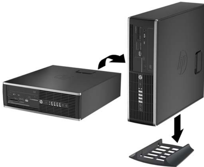
Abbildung 3-6 Umwandeln des Desktop-Systems in ein Tower-System
