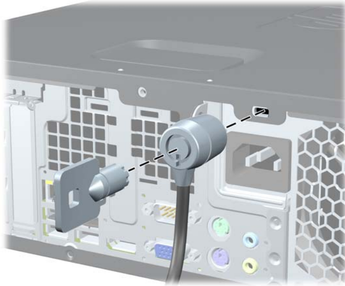
Abbildung 3-40 Anbringen einer Kabel-Diebstahlsicherung
