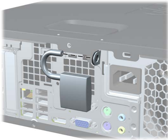
Abbildung 3-41 Anbringen eines Vorhängeschlosses
