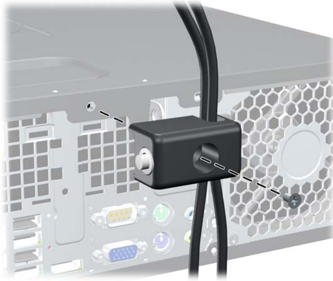
Abbildung 3-47 Befestigen der Sperre am Gehäuse
