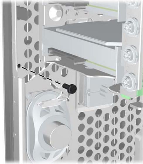
Abbildung 2-43 Installieren der Sicherheitsschraube für die Frontblende
