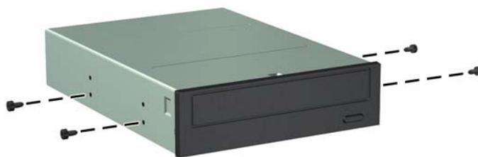
8. En veillant à aligner les têtes de vis sur les rainures de guidage, faites glisser l'unité dans son compartiment jusqu'à son enclenchement.
