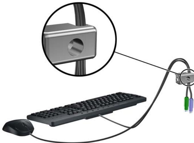
6. Vissez le verrou au châssis dans le trou de la vis à ailettes à l'aide de la vis fournie.
