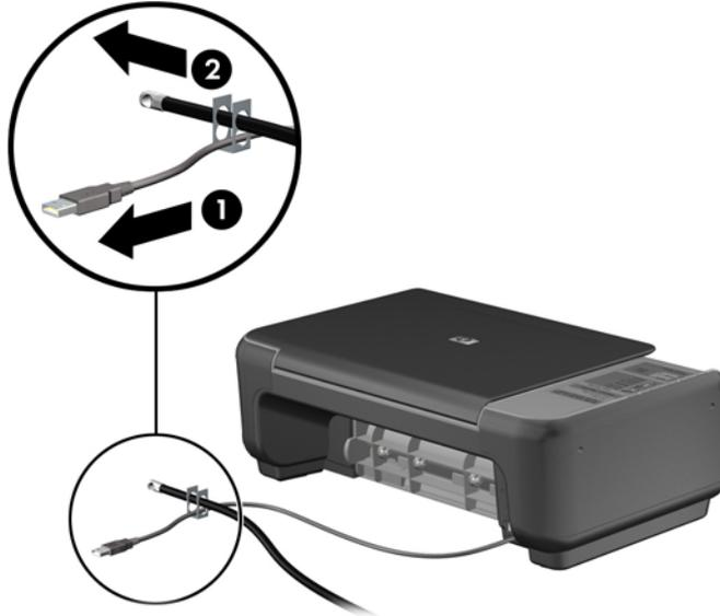
5. Enfilez les câbles du clavier et de la souris dans le verrou du châssis de l'ordinateur.
