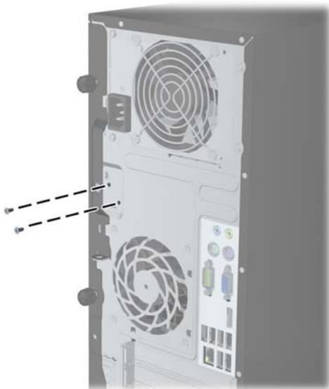
**Figure C-2** Retrait des vis du verrou du capot intelligent de l'ordinateur compact
