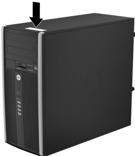
**Figure 1-9** Emplacement du numéro de série et de l'ID de produit de l'ordinateur compact
