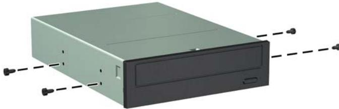
9. Posizionare le viti guida dell'unità negli slot J nell'alloggiamento unità. Quindi, far scorrere l'unità in direzione della parte anteriore del computer fino a quando non scatta in posizione.
