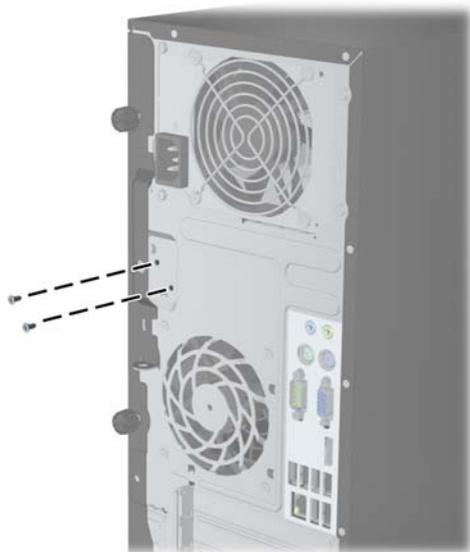
**Figura C-2** Rimozione delle viti di blocco del coperchio dall'SFF
