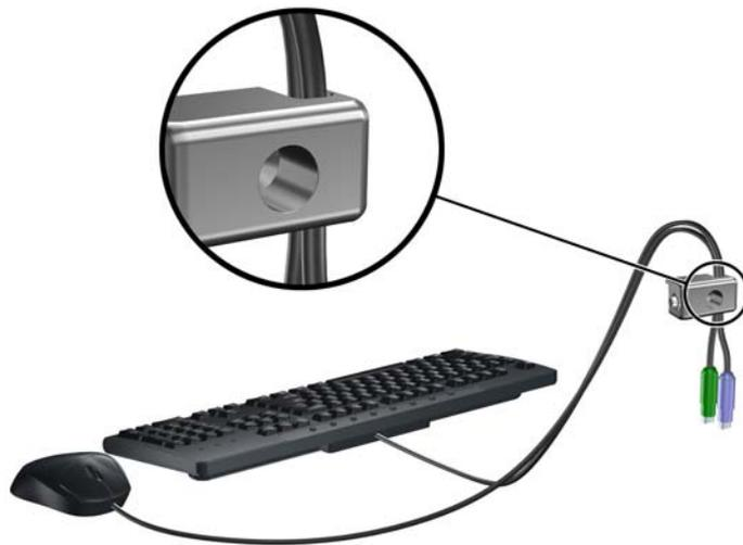
6. Avvitare il blocco allo chassis nel foro della vite a testa zigrinata mediante la vite fornita.
