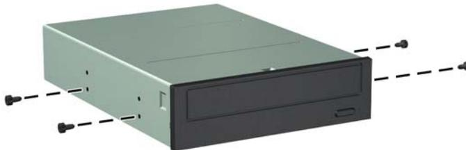
8. Infilare l'unità nell'alloggiamento, allineando le viti ai fori, fino a che non si blocca.
