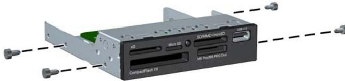
4. Posizionare le viti guida dell'unità negli slot J nell'alloggiamento unità. Quindi, far scorrere l'unità in direzione della parte anteriore del computer fino a quando non scatta in posizione.
