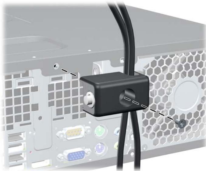
7. Inserire l'estremità della spina del cavo di sicurezza nel fermo (1) e premere il pulsante (2) per attivare il blocco. Per disattivarlo, utilizzare la chiave fornita.
