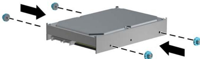
12. Allineare le viti guida agli slot dell'alloggiamento dell'unità, spingere l'unità nell'alloggiamento, quindi reinserirla fino a bloccarla in sede.
