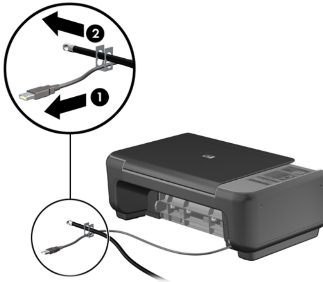
2-37. ábra: Perifériaeszközök rögzítése (az ábrán nyomtató látható)
