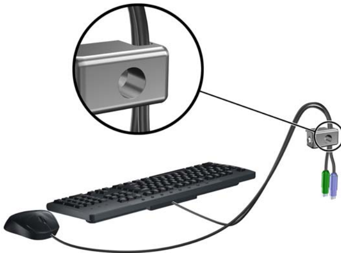
3-46. ábra: A billentyűzet és az egér kábeleinek átfűzése
