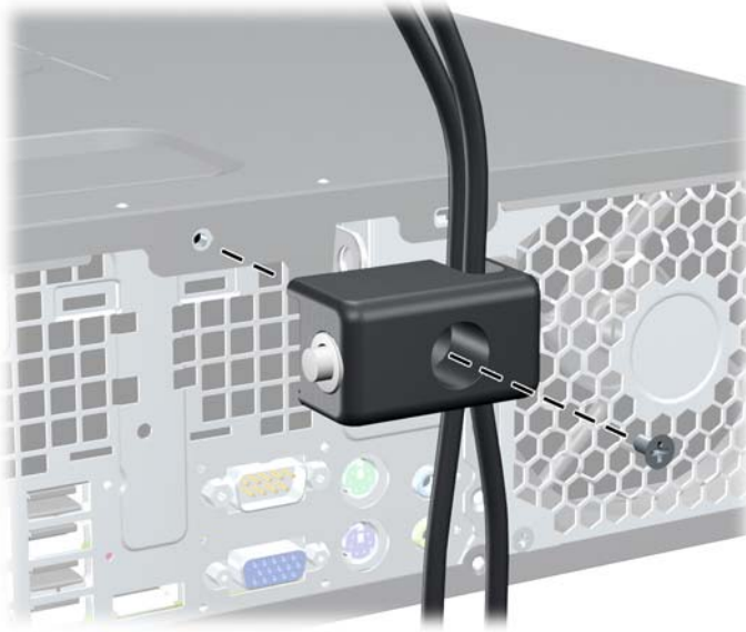
3-47. ábra: A zár rögzítése a gépházhoz
