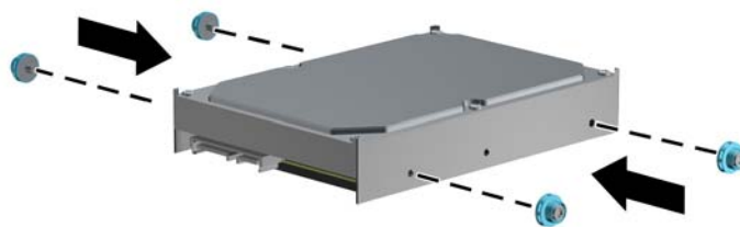
Gambar 2-26 Memasang Sekrup Pemandu Pemasangan Isolasi pada Drive berukuran 3,5 inci
