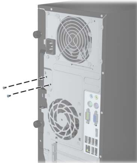
Gambar C-1 Membuka Sekrup Smart Cover Lock dari Microtower
