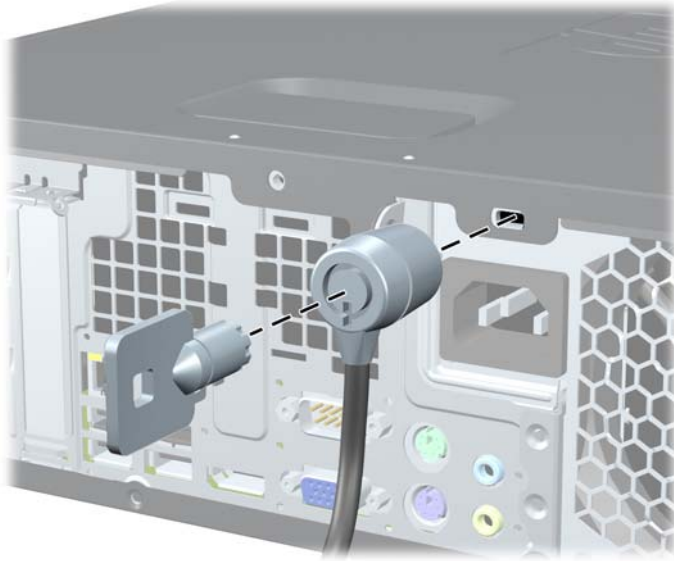
Gambar 3-40 Memasang Kunci Kabel
