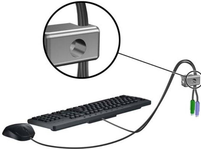
Gambar 2-38 Memasukkan Kabel Keyboard dan Kabel Mouse ke dalam lubang kunci.
