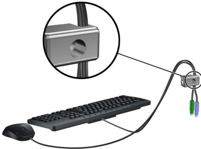
Gambar 3-46 Memasukkan Kabel Papan Ketik dan Kabel Tetikus
