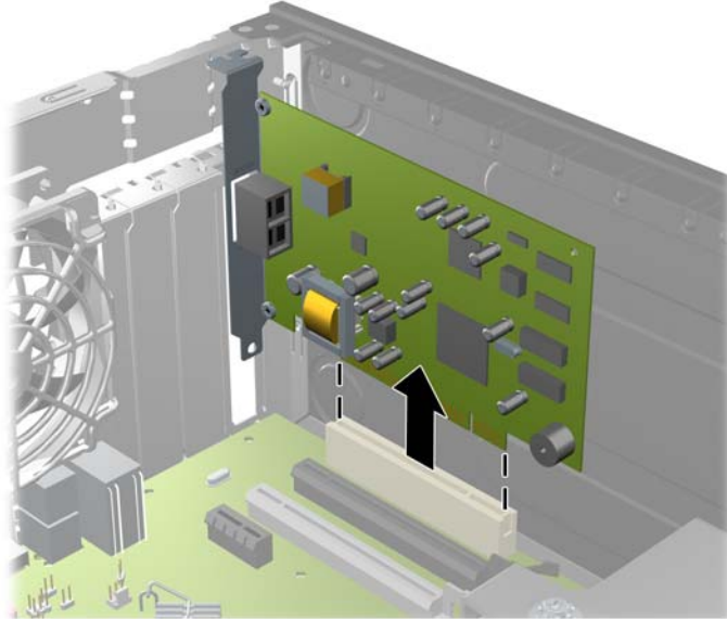
Gambar 2-11 Melepaskan Kartu Ekspansi PCI Standar
