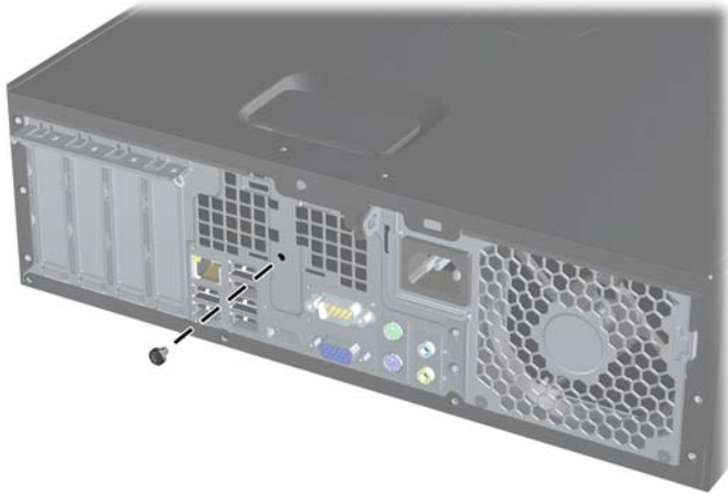
Gambar C-2 Membuka Sekrup Smart Cover Lock dari Small Form Factor
