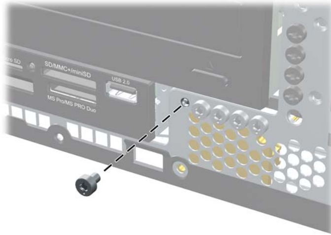
Slika 3-50 Uklanjanje zavrtnja koji obezbeđuje prednju masku
