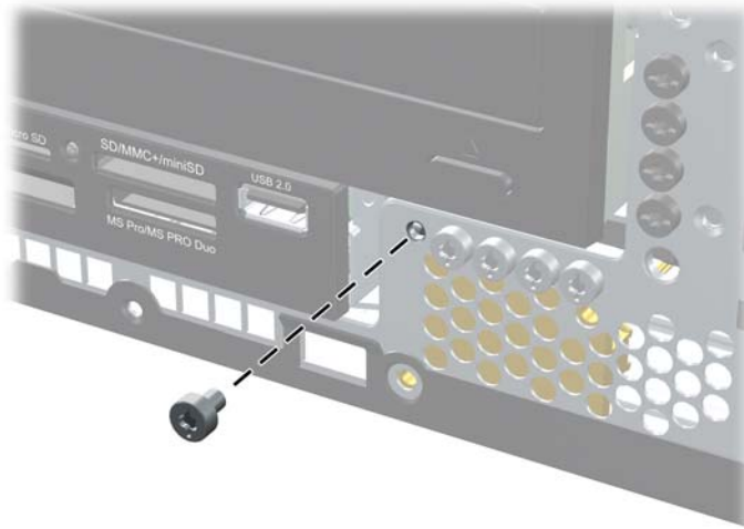
Joonis 3-50 Esikatte kinnituskruvi tagasipanek
