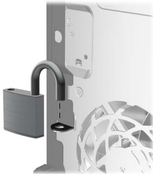
Joonis 2-33 Tabaluku paigaldamine
