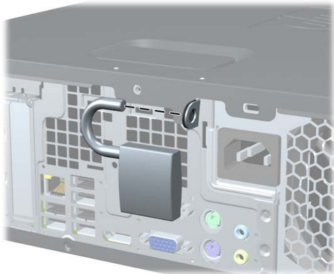
Joonis 3-41 Tabaluku paigaldamine
