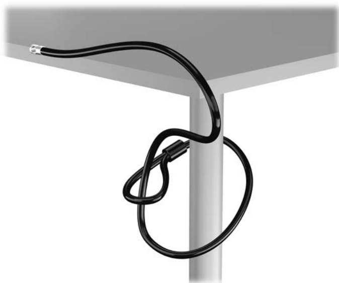
Joonis 3-42 Kaabli kinnitamine fikseeritud objekti külge
