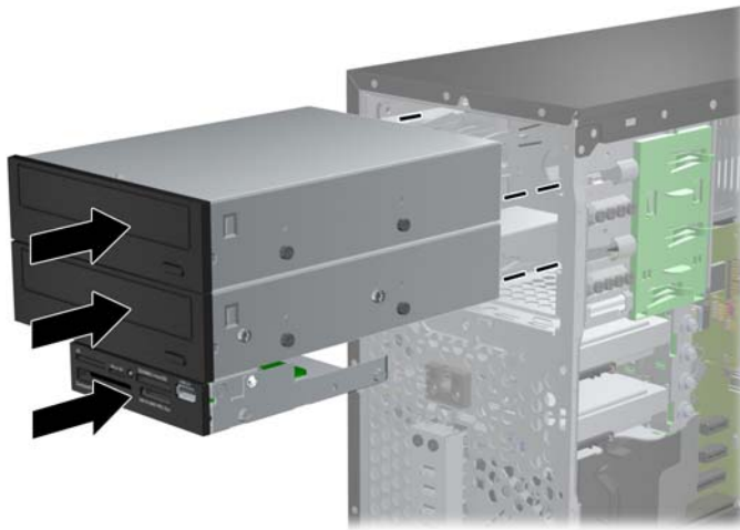
Joonis 2-21 Kettaseadmete paigaldamine kinnituskorpusesse
