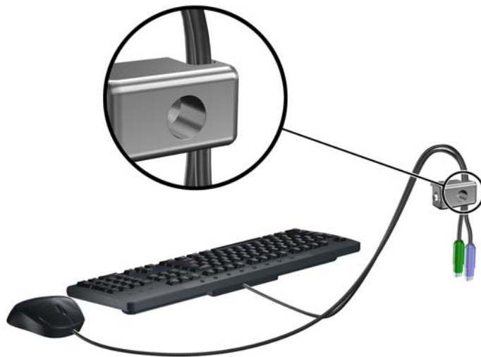
Joonis 2-38 Klaviatuuri ja hiire ühenduskaablite kinnitamine
