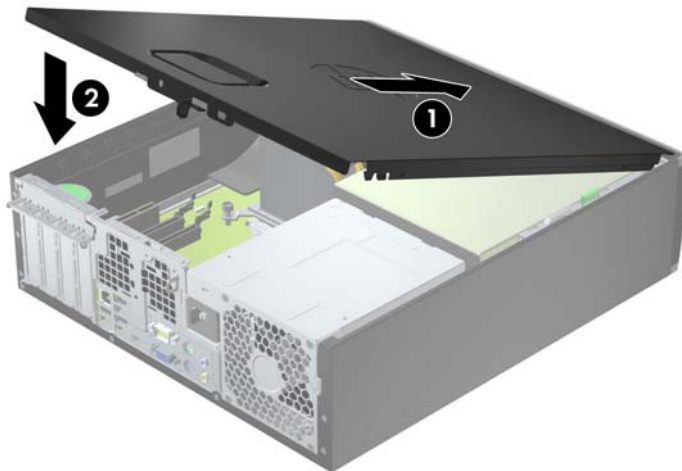
Joonis 3-2 Arvuti külgpaneeli tagasipanek
