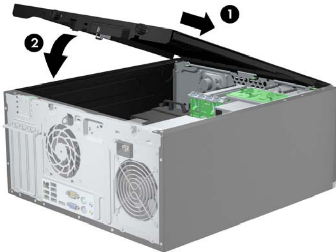
Joonis 2-2 Arvuti külgpaneeli tagasipanek
