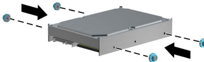
Joonis 3-37 Kõvaketta kinnituskruvide paigaldamine
