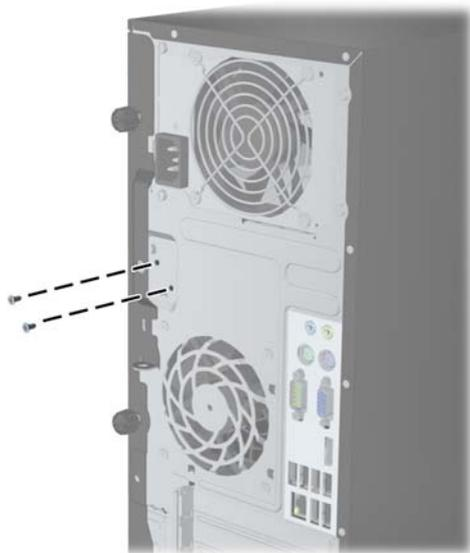
**Figura C-2** Extracción de los tornillos del bloqueo inteligente de cubierta del Equipo Compacto
