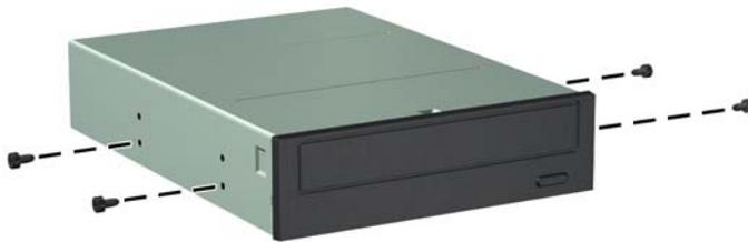
9. Coloque los tornillos guía en la unidad en las ranuras J en el compartimiento de la unidad. Luego deslice la unidad hacia la parte frontal del equipo hasta que encaje en su lugar.
