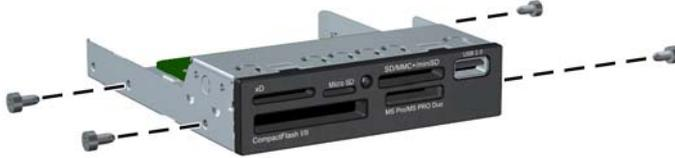
4. Coloque los tornillos guía en la unidad en las ranuras J en el compartimiento de la unidad. Luego deslice la unidad hacia la parte frontal del equipo hasta que encaje en su lugar.
