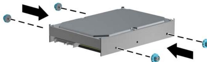
12. Alinee los tornillos guía con las ranuras en el chasis del compartimiento de la unidad, presione la unidad de disco duro en el compartimiento, luego deslícela hacia atrás hasta que se detenga y se encaje en su lugar.
