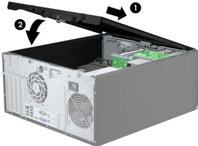
2. Asegúrese de que el panel cierre completamente (1) y ajuste los dos tornillos de apriete manual que fijan el panel de acceso al chasis (2).
