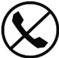
標示有此符號的 RJ-45 插座代表網路介面連線 (Network Interface Connection, NIC)。
