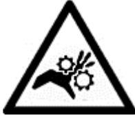
這些符號表示含有可能造成夾傷，壓傷或其他身體傷害的機械零件。
