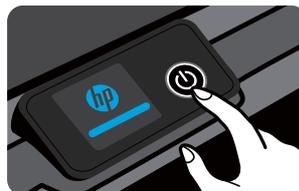
電源コードを接続します。Ⓞをタッチしてプリンターの電源を入れます。
