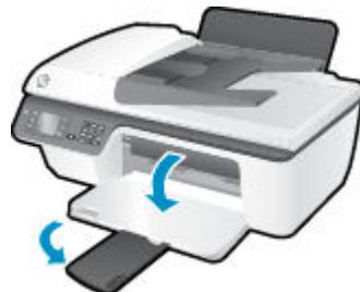
3. 提起進紙匣檔板，並向左滑動紙張寬度導板。
