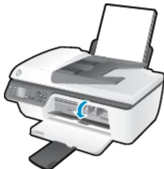
3. 取出控制台中閃爍墨水匣燈號所指示的墨水匣。
