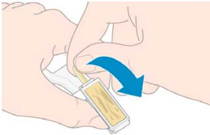
12. Nehmen Sie den verschmutzten Schwamm aus dem Werkzeug.
