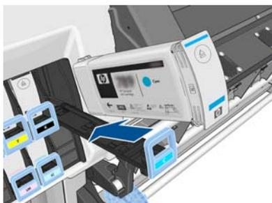
5. Schieben Sie den Einschub mit dem Behälter in den Schacht, bis er einrastet.
