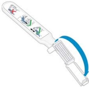
3. Setzen Sie den Schwamm wie gezeigt mit dem kürzeren Fortsatz in die Öffnung am Werkzeug ein.
