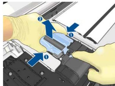
8. Entfernen Sie die Halterung der Tintenleitung und die Tintenleitung.
