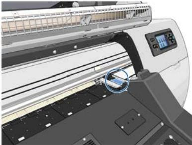
7. Ziehen Sie mit einem Finger am Schieber, und entfernen Sie den Tintentrichter gleichzeitig mit der anderen Hand.
