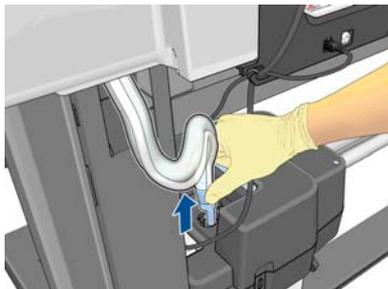
4. Setzen Sie die Ersatzkappe des Tintenwartungskits auf die alte Tintenleitung auf, damit keine Tinte aus der Leitung austritt.
