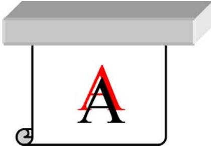
Wenn Farben versetzt gedruckt werden, sind die Druckköpfe möglicherweise nicht ausgerichtet. Dies ist wahrscheinlich, wenn die Druckköpfe lange Zeit nicht ausgerichtet wurden oder kürzlich ein Druckmaterialstau aufgetreten ist. Richten Sie die Druckköpfe ggf. aus (siehe [Ausrichten der Druckköpfe auf Seite 11](#)). Sie können anhand des Druckkopf-Statusplots überprüfen, ob die Ausrichtung erforderlich ist (siehe [Verwenden des Druckkopf-Statusplots auf Seite 55](#)).
