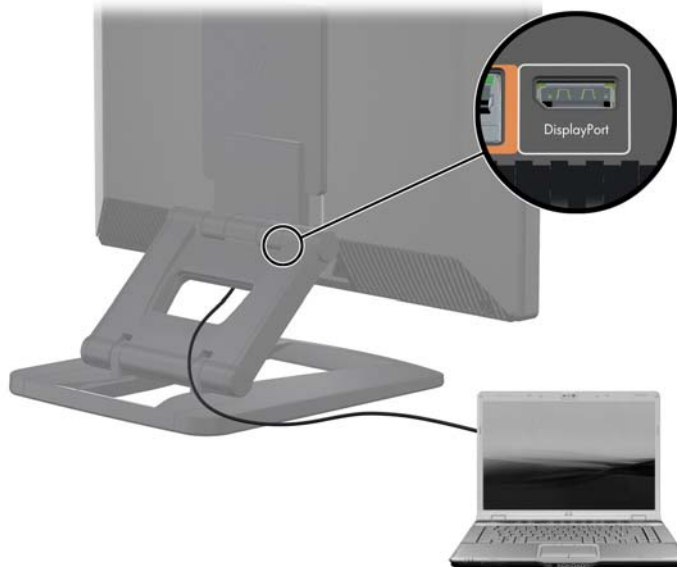
Abbildung 3-15 Verbinden der Display-Anschlüsse
