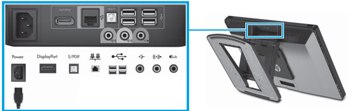
Abbildung 3-4 Verbinden Sie die Kabel mit der unteren E/A-Abdeckung
