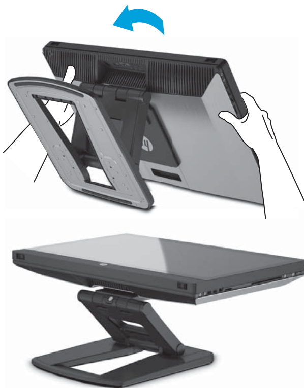
Abbildung 3-5 Kippen Sie die Einheit zu sich nach dem Anschluss der Kabel
