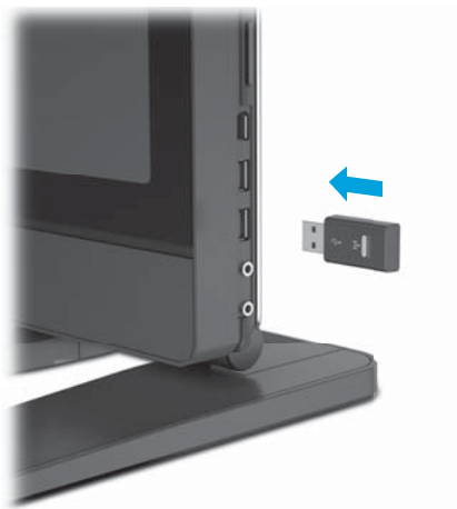
Figure 3-8 Insérez le dongle dans le port USB latéral de l'appareil
