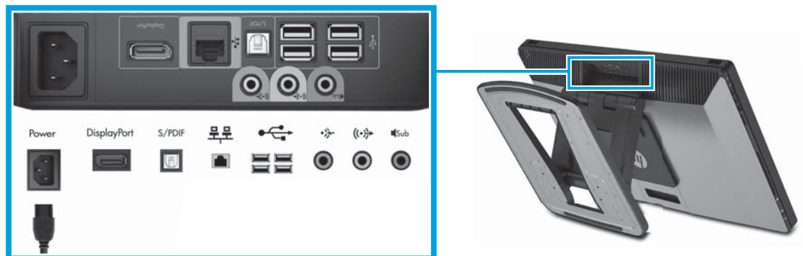
Figure 3-4 Raccordez les câbles au panneau E/S inférieur
