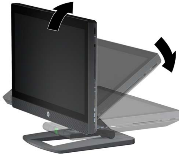
Figure 3-11 Abaissement de la station de travail en position horizontale
