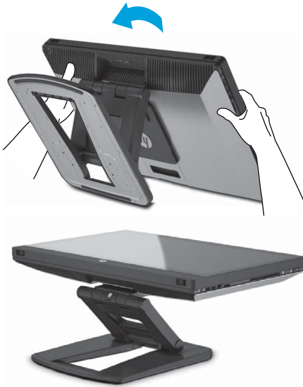
Figura 3-5 Inclinare l'unità verso di sé dopo aver collegato i cavi
