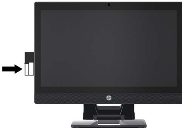
Figura 8-1 Posizione dell'etichetta di manutenzione all-in-one
