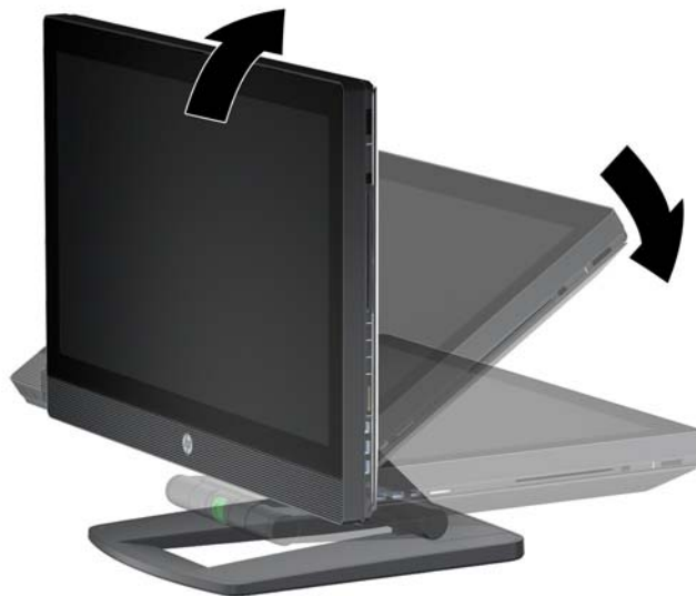
Figura 3-11 Manovrare la workstation fino a farle raggiungere la posizione orizzontale
