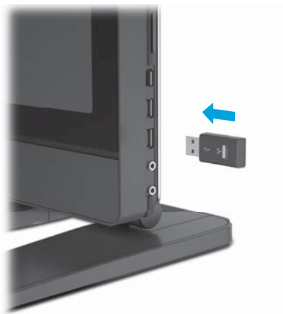
Figura 3-8 Inserire il dongle in una porta USB laterale
