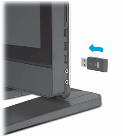
Afbeelding 3-8 Plaats de dongle in een USB-poort aan de zijkant
