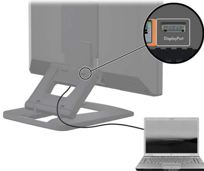
Afbeelding 3-15 Het aansluiten van de DisplayPorts
