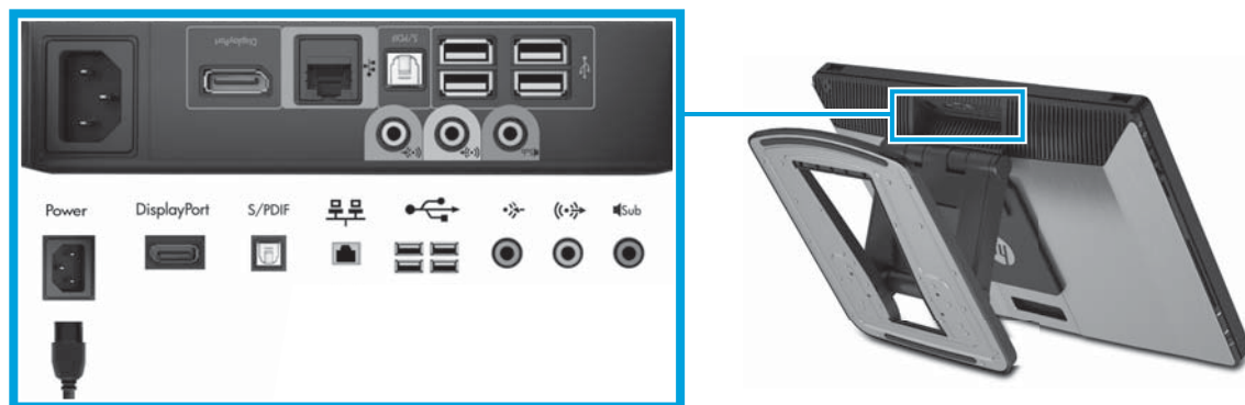
图 3-4 将电缆连接到较低的 I/O 面板
