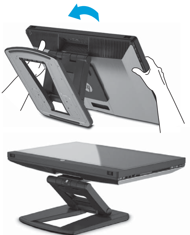
图 3-5 连接完线缆后，将机器朝您的方向倾斜
