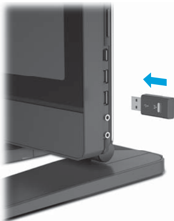
图 3-8 将 Dongle 插入机器侧面的 USB 端口
