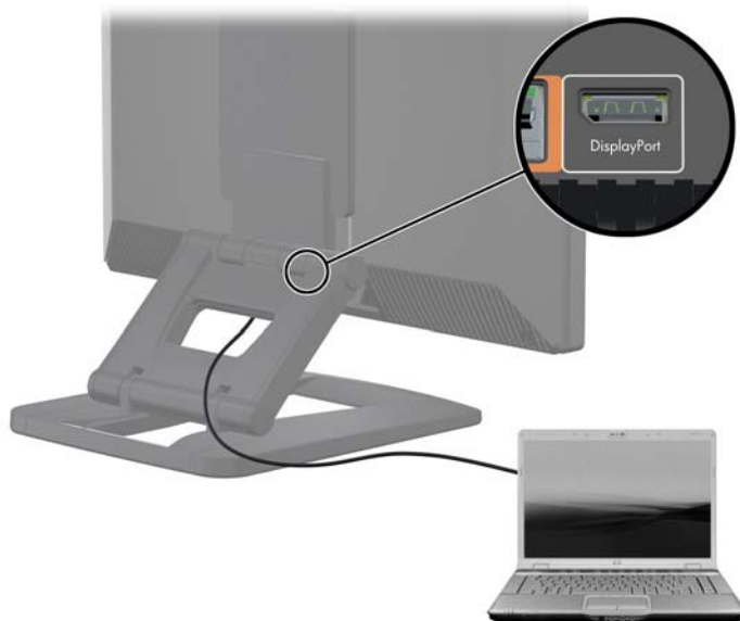
图 3-15 连接显示器端口
