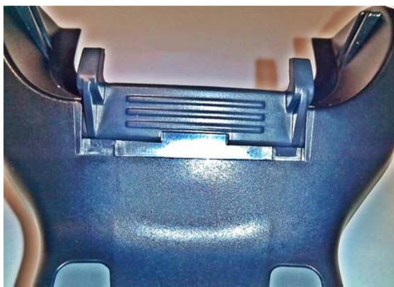
Vérifiez que les clips arrière sont présents et correctement insérés. L'absence du clip arrière pourrait empêcher l'engagement correct des contacts de charge en position chevalet ou verticale.
