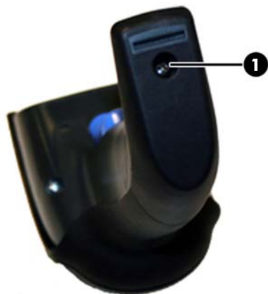
ภาพ 4-8 การถอดฝาปิดแบตเตอรี่
