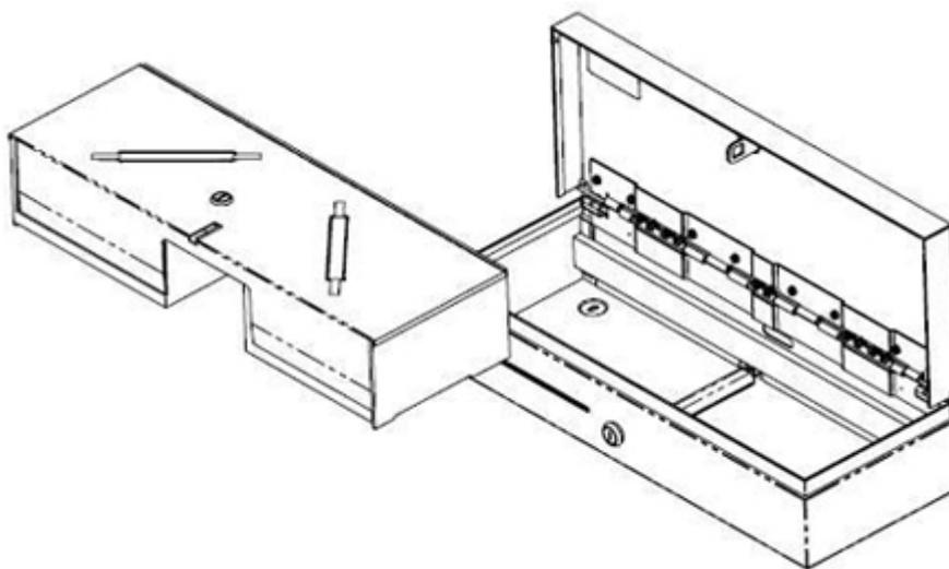
2. 將現金抽屜中鎖定的置放槽蓋取出：首先鑰匙插入安全鎖 (1) 中並轉動 90 度，然後握住置放槽的兩個把手 (2)，將置放槽蓋從現金抽屜中取出。
