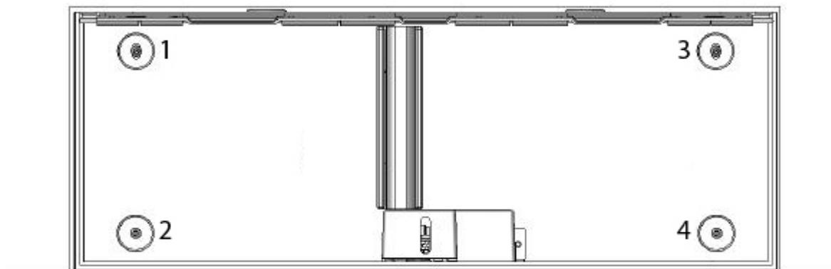
3. 將四個固定螺絲穿透機殼內側底部的螺絲孔，藉此將現金抽屜固定在工作平面上。
