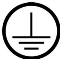
Identifie la borne de mise à la terre PE (Protective Earth). Elle se situe à l'intérieur du boîtier de commandes électriques.
