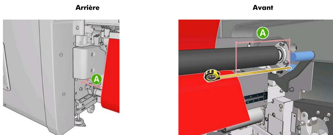
15. Une fois le bord du substrat correctement placé et le substrat sous tension uniforme, abaissez la manette du rouleur de tension.
