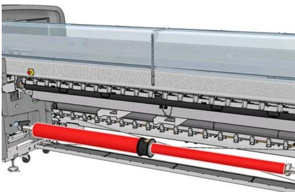
8. Posez les extrémités de la bobine sur les plates-formes à l'arrière de l'imprimante ; des coussinets en plastique sont fournis pour absorber les impacts.
