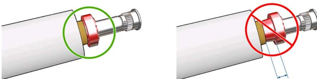
11. Certifique-se de que o núcleo do rolo se encaixa firmemente no hub diferencial.
