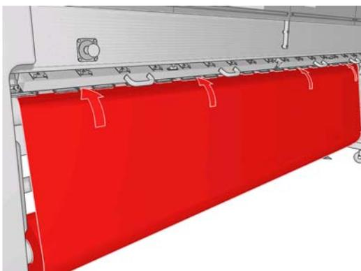
12. De frente para a impressora, se você achar que não desenrolou uma quantidade suficiente de substrato, selecione **Start main roller motion** (Iniciar movimentação do rolete principal) para desenrolar mais substrato. O substrato só se desenrola quando é puxado.
