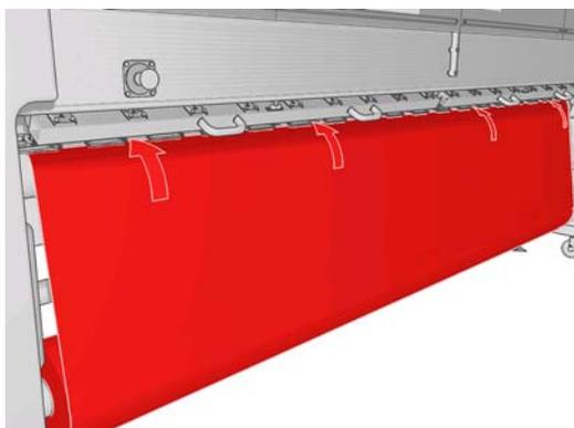
13. De frente para a impressora, se você achar que não desenrolou uma quantidade suficiente de substrato, selecione **Start main roller motion** (Iniciar movimentação do rolete principal) no painel frontal para desenrolar mais substrato. O substrato só se desenrola quando é puxado.
