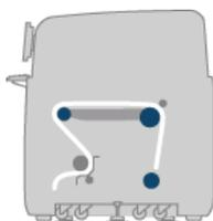
O rolo de substrato é montado no eixo traseiro; o substrato para impressão será depositado no chão, na frente da impressora. O caminho percorrido pelo substrato é: eixo traseiro (1), rolete principal (3), cilindro, rolete frontal (5) e rolete da tensão (7), então, cai no chão. Os roletes do conversador (2 e 6) e os coletores de tinta (4) são instalados ao imprimir em substratos porosos.
