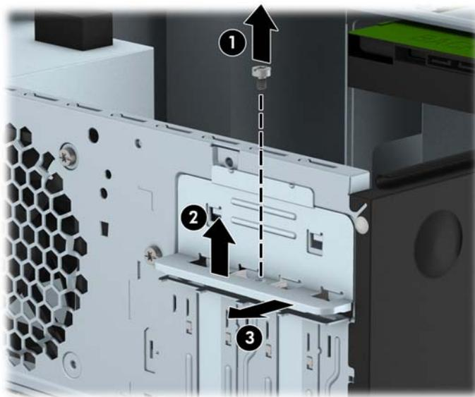
7. Ermitteln Sie den benötigten freien Erweiterungssteckplatz auf der Systemplatine und den zugehörigen Ausgang auf der Gehäuserückseite.
