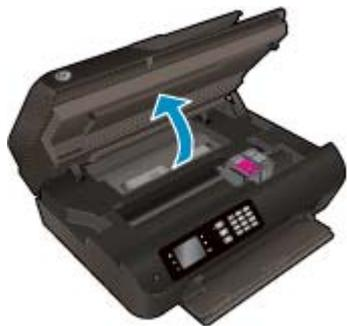
Espera hasta que el carro de impresión se desplace hacia el lado derecho de la impresora.
