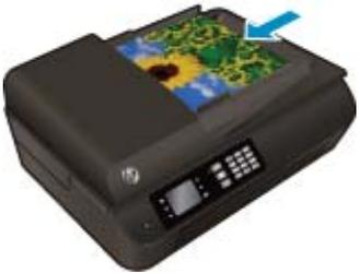
3. Deslice las guías de anchura del papel hacia adentro hasta que entren en contacto con el borde del papel.
