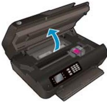
Espere hasta que el carro de impresión se desplace hasta el centro de la impresora.
