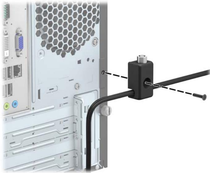
7. Insira o plugue do cabo de segurança no bloqueio (1) e pressione o botão (2) para prender o bloqueio. Use a chave fornecida para desprender o bloqueio.
