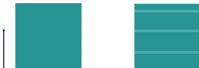
Patrón 1 original afectado por bandas periódicas horizontales
