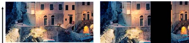
Escaneado de original afectado por el fallo de un módulo CIS
