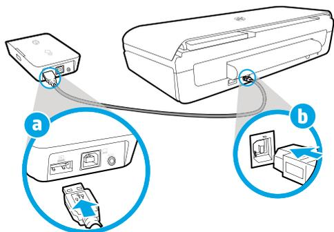
3. Mettez l'accessoire d'impression mobile sans fil sous tension, avec l'alimentation de l'imprimante, à l'aide d'un autre câble USB (non fourni).
