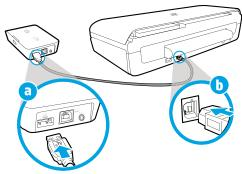
Verwenden Sie ein weiteres (nicht mitgeliefertes) USB-Kabel, um das Wireless-Mobildruckzubehör über den Drucker mit Strom zu versorgen.
