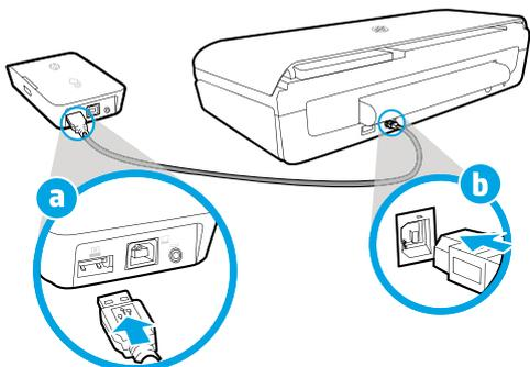
3. Utilizzando un ulteriore cavo USB (non in dotazione), alimentare l'accessorio di stampa mobile wireless collegandolo alla stampante.
