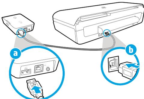
3. Con un cable USB adicional (no incluido), alimente el accesorio de impresión móvil inalámbrico en la impresora. Necesitará un cable USB adicional (no suministrado con el accesorio inalámbrico).
