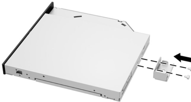
Figura 2-46 Instalação do suporte da unidade de disco óptico
