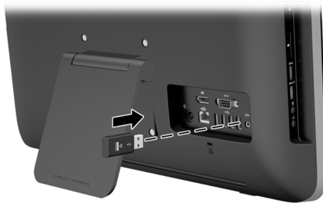
Figura 2-4 Instalação do receptor sem fio
