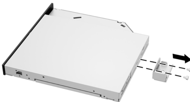
Figura 2-45 Extracción del soporte de la unidad de disco óptico.
