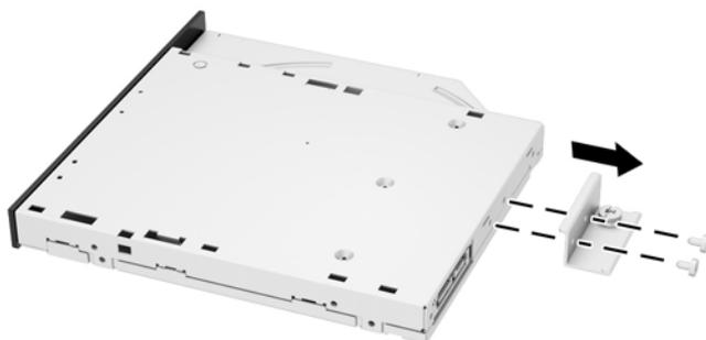
11. Collegare la staffa dell'unità disco ottico alla nuova unità disco ottico avvitando le due viti attraverso la staffa sulla nuova unità.
