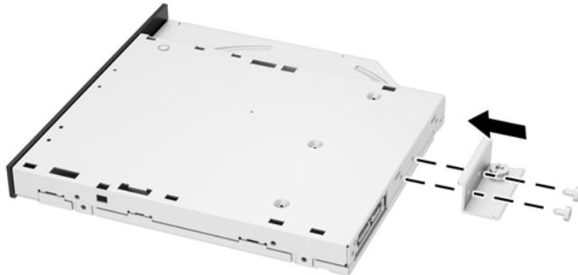
12. Posizionare la nuova unità disco ottico nel telaio e spingere l'unità con decisione fino a farla scattare in posizione (1).
