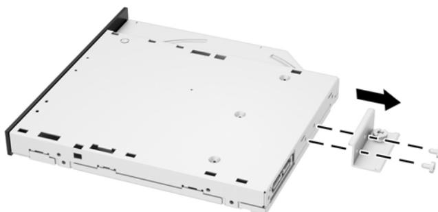
11. Conecte o suporte da unidade de disco óptico à nova unidade de disco óptico apertando os dois parafusos através do suporte na nova unidade.
