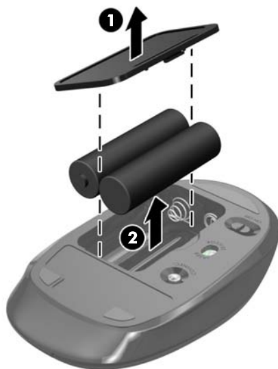
Slika 3-6 Uklanjanje baterija iz bežičnog miša
