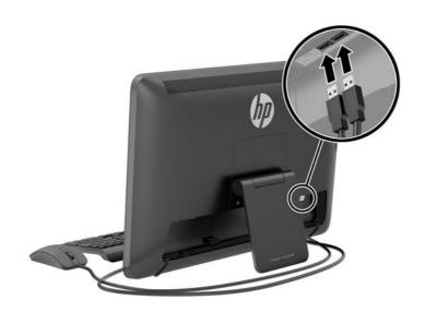
5. 如果您想要連接 HDMI 裝置,請將 HDMI 纜線連接到 All-in-One 產品後面面板上的 HDMI 連接埠(1),再連接到 HDMI 裝置 (2)。
