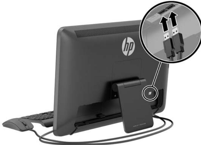
5. Si desea conectar un dispositivo HDMI, conecte un cable HDMI al puerto HDMI del panel trasero del dispositivo multifuncional (1) y luego a a un dispositivo HDMI (2).
