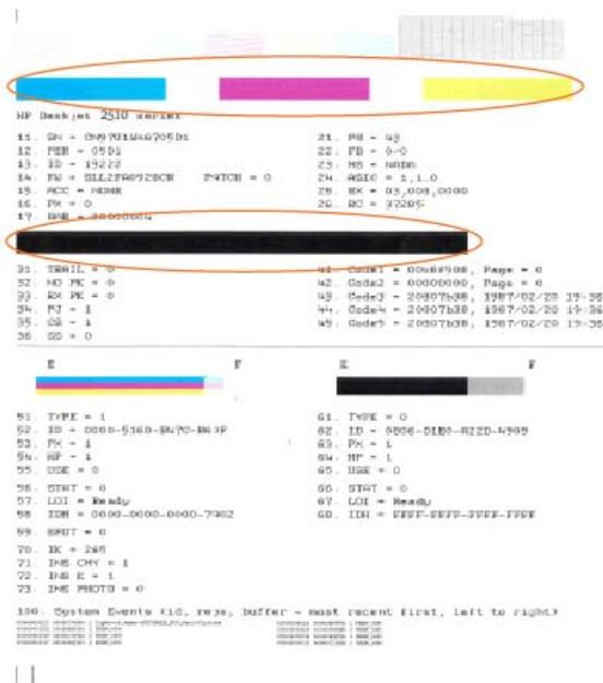
6. 診断ページのカラーおよび黒のボックスに線が入っていたり、ボックス内に印刷されていない箇所がある場合は、カートリッジの自動クリーニングを実行します。
